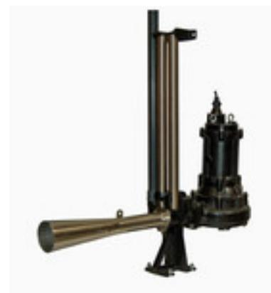
Dieser Tauchbelüfter (Ejektor) besteht aus einer Pumpe mit einer Strahlvorrichtung, wodurch das Wasser zur selben Zeit bewegt und belüftet wird. Die Pumpe ist mit einem verstopfungsfreien Kanallaufwerk ausgestattet.
