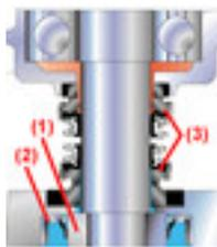
Alle Tsurumi-Pumpen verfügen über ein 2-faches Dichtungssystem für längere Standzeiten:
