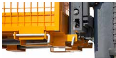
Einfahrtsschutz an den nicht verwendeten Einfahrtstaschen
