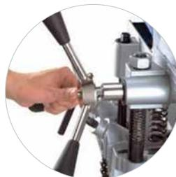
Bedienkreuz werkzeuglos auf beiden Seiten einsetzbar
