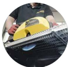
Ideal für Gitterroste mit LBS-Sägeblatt
