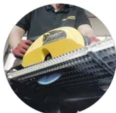
Ideal für Gitterroste mit LBS-Sägeblatt schockresistent
