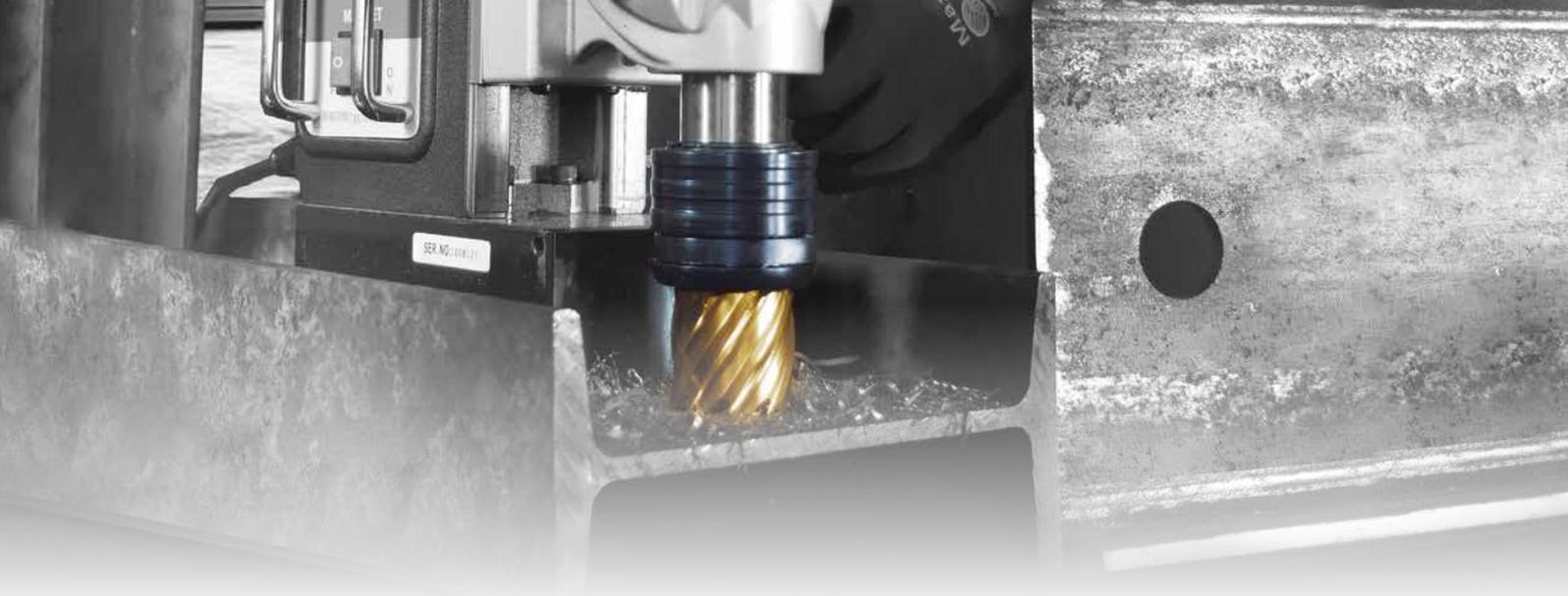
**TiN** bedeutet eine sehr hohe Abriebfestigkeit und eine geringe Reaktivität. Deswegen wird der Werkzeugverschleiß durch Beschichtung entscheidend herabgesetzt. Die TiN Beschichtung ermöglicht eine Zerspanung von harten Stählen wie zum Beispiel ST 52 und Edelstahl (im Gegensatz zu HSS-Co für herkömmliche Stähle).
