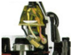
Eine kriechwassergeschützte Kabeleinführung dichtet die Pumpe gegen eindringendes Wasser ab. Da bei unseren Pumpen ein Stück jeder Phase abisoliert und die Kabeleinführung mit Kunstharz bzw. Gummi ausgegossen ist, kann garantiert kein Wasser durch die Drähte (Kapillarkräfte) zum Motor wandern. Ein Kurzschluß ist so ausgeschlossen.
