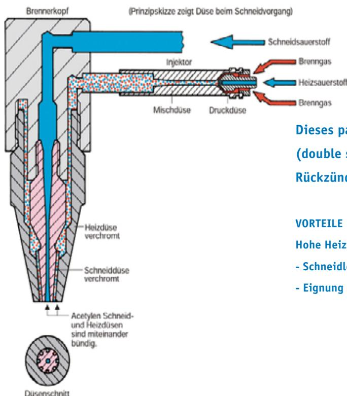
Dieses patentierte Sicherheitsinjektorsystem (double safety-injector) gewährleistet höchste Rückzündsicherheit bei sämtlichen Acetylendrücken.
