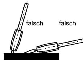
Brenner vorsichtig auf Oberfläche aufsetzen. Brennerreinigung zur Oberfläche 45°. Die Spitzen der Flammkegel müssen die Oberfläche berühren.
