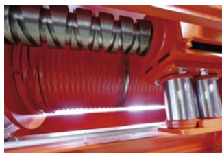
Seilverlegeeinrichtung mit Kreuzwelle Spooling system with cross shaft Guide câble avec arbre croix
