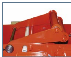
Schlaffseilschalter (3) Slack-rope switch (3) Détection de brin mou (3)
