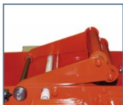
Schlaffseilswitch Slack-rope switch Détection de brin mou
