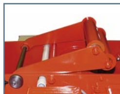
Schlaffseilswitcher Slack-rope switch Détection de brin mou
