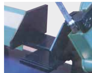
Schraubstock mit verlängerten Spannbacken und Werkstückauflage
