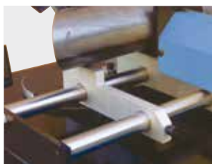
Verstellen des Schraubstocks für Gehrungsschnitte
