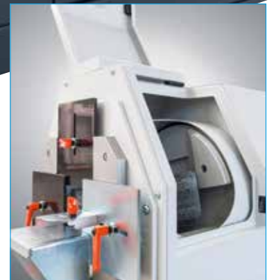
Geöffneter Arbeitsraum mit Endschalter, gute Zugangsmöglichkeit
