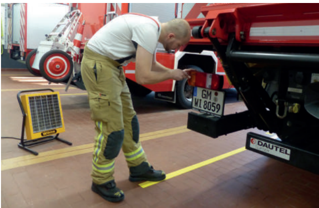
Punktbeheizung statt Raumbeheizung bei Arbeiten in der Fahrzeughalle
