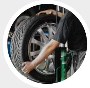
Die kugelgelagerte Rollen vereinfachen Drehbewegungen und das Positionieren vom Rad.
