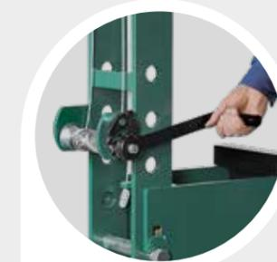
Schnelle und sichere Tischhöhenverstellung über einen einzeln gebremsten Kurbel.
