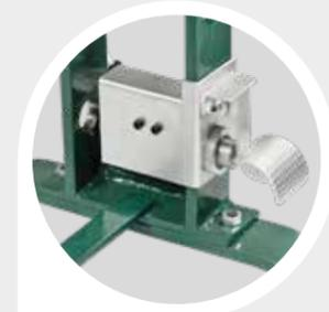
Fußbedienter Schnellhub des Kolbens mit Druckluft. (FP 20/FP 25/FP 30)
