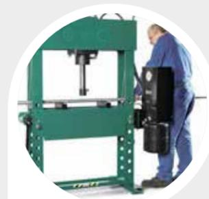
90 Grad ausschwenkbare Pumpeneinheit ermöglicht ein einfacheres Einsetzen längerer Werkstücke.
